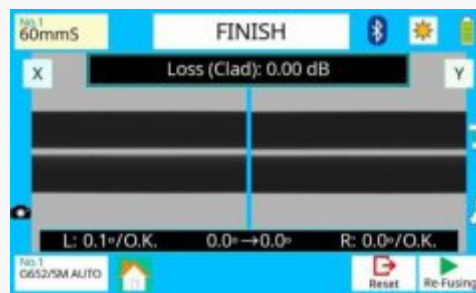
Strata v zvare s veľkým uhlom štiepenia: 3 < \theta < 5 stupňov
