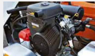
Vanguard EFI. Tichý, 2-taktný benzínový motor - 37 koní.
